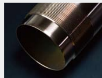
ハイクオリティなサーフェイス 材質：ニッケルクロム合金 (nicr39-03) コーティング膜厚：35ミクロン
