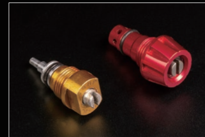
スタンダード (左) はフォーク内部の大きなオイル流路に直接ニードル用いて流路コントロールをするのに対して、Technix (右) ではアジャスターで一層流路を制限し、制限されたオイルに対してアジャスターニードルで更にオイル流量を制限することで繊細で確実なアジャストを可能とする
