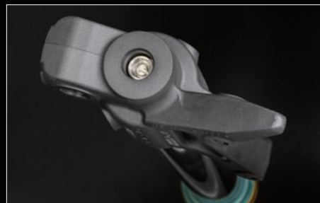
フォーク下部に外部から調整出来るように新設された コンプレッションアジャスター装着例 (CRF250L)
