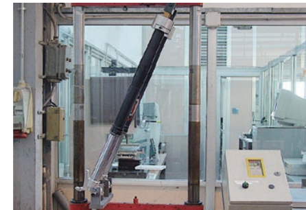
100 万サイクルに渡る耐久テスト。車種装着状態の角度でテストされる。
