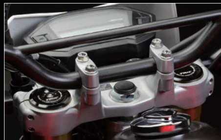
トップボルトに装着されたリバウンドアジャスター装着例 (CRF250L)
