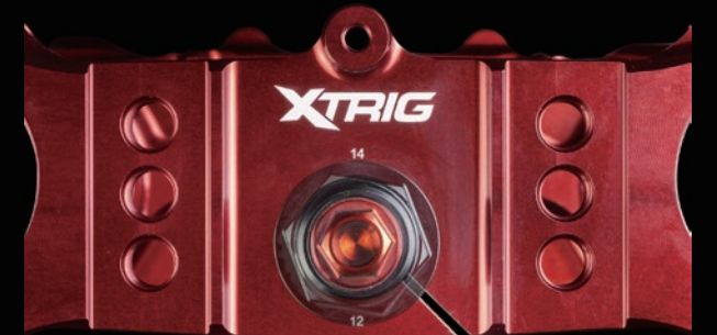
YZ450F (2018-2020) 用：スタンダードオフセット 22mm から 12-14mm のアジャスタブルオフセットへ大幅にオフセット量を減らしたモタード専用クランプ。トレール量の適正化でハンドリングの安定感が得られる。
