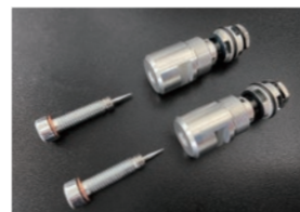
リバウンドバルブ側カートリッジ内部 (TRIC)
