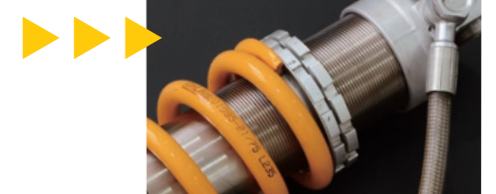
スチール製ショックボディの再めっきの一例。外面を綺麗にするだけでなく、内面へコーティングすることで摺動性を向上させるのが Technix 流。
