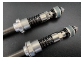
リバウンドバルブ側カートリッジ内部 (TRIC)
