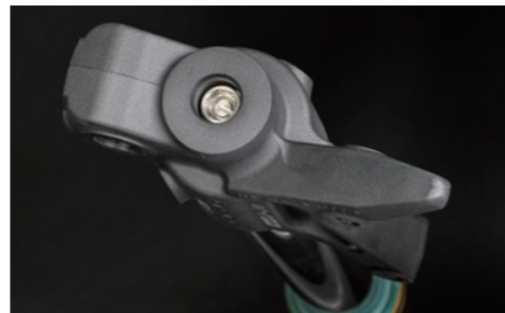
フォーク下部に外部から調整出来るように新設された コンプレッションアジャスター装着例 (CRF250L)
