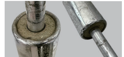
ショックボディが折り返されることで「カシメ」られている完全非分解タイプのショックの一例。このようなタイプ、または同箇所を溶接で非分解とするタイプも Technix の技術力とアイデアで分解、レストアを可能とした。
