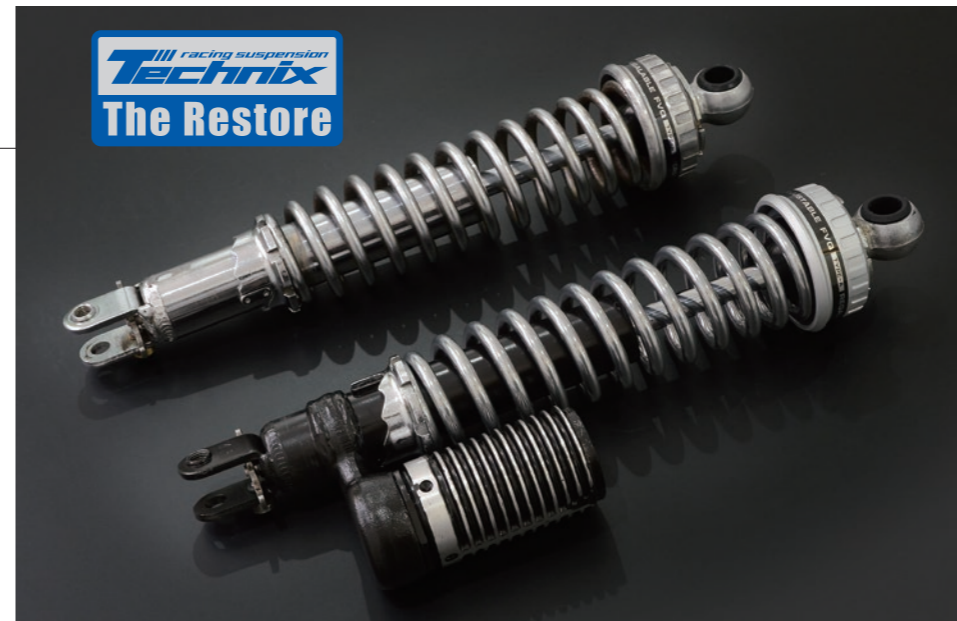
ショックボディが折り返されることで「カシメ」られている完全非分解タイプのショックの一例。このようなタイプ、または同箇所を溶接で非分解とするタイプも Technix の技術力とアイデアで分解、レストアを可能とした。
