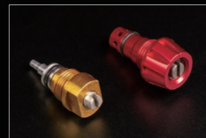
スタンダード (左) はフォーク内部の大きなオイル流路に直接ニードル用いて流路コントロールをするのに対して、Technix (右) ではアジャスターで一度流路を制限し、制限されたオイルに対してアジャスターニードルで更にオイル流量を制限することで繊細で確実なアジャストを可能とする
