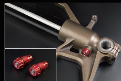
フォーク下部に装着されるアジャスター機構 (1部の車種を除き左右セット1台分での販売)
