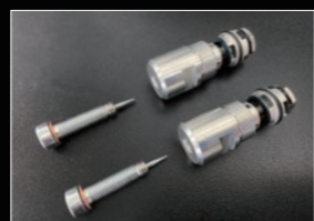
コンプレッションバルブ側カートリッジ内部 (TRIC)
